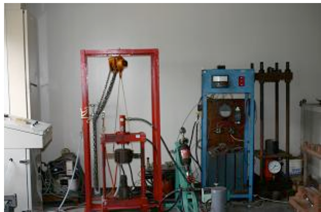
図4. 水熱ホットプレス装置
